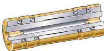
Узел "палец-втулка" ходовой части SystemOne
