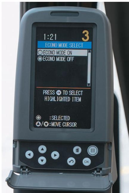
**Монитор.** В кабине установлен полноцветный жидкокристаллический (ЖК) графический дисплей с разрешением 400 x 234 пикселя. Угол наклона монитора можно отрегулировать, чтобы минимизировать солнечные блики. Информация на мониторе отображается на одном из двадцати семи языков.
