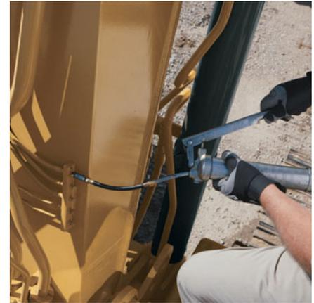
**Возможность обслуживания с уровня земли.** Конструкция и компоновка машины 336D разрабатывались с целью облегчения работы специалиста по обслуживанию. Большинство точек обслуживания доступны с уровня земли, что позволяет быстро и эффективно проводить наиболее важные работы по техническому обслуживанию.
