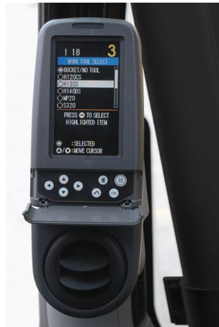
**Система управления навесным оборудованием.** Опциональная система управления навесным оборудованием максимально увеличивает производительность оборудования за счет подбора расхода жидкости в гидросистеме, давления и органов управления оператора для конкретного инструмента. Универсальность системы позволяет использовать широкий ассортимент инструментов.
