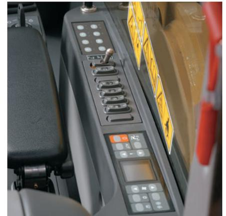
**Консоль управления.** Измененная простая и функциональная конструкция консолей управления снижает утомляемость оператора, упрощает выполнение переключений и дает отличную обзорность. Обе консоли оборудованы подлокотниками с системой настройки по высоте.
