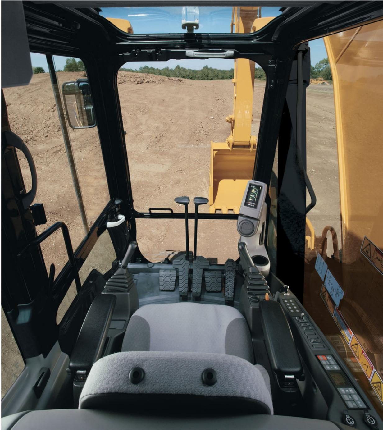
**Рабочее место оператора.** Рабочее место оператора просторно и удобно, имеет надежную шумоизоляцию, что помогает оператору сохранять высокую производительность на протяжении всей рабочей смены. Система кондиционирования воздуха и переключатели навесного оборудования удобно расположены на правой стенке; пусковой переключатель двигателя и шкала частоты вращения двигателя расположены на правой консоли. Монитор установлен перед правой передней стойкой кабины и хорошо виден.
